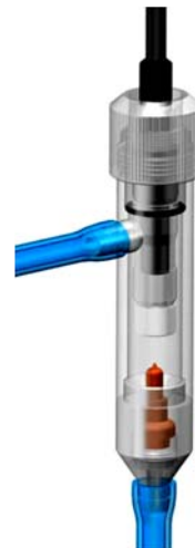
Рис. 3.7. Фиксация АСрН 2 в измерительной камере.
